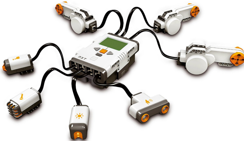
Figura 2.6: Il componente principale del sistema Lego NXT con alcuni sensori e motori collegati
